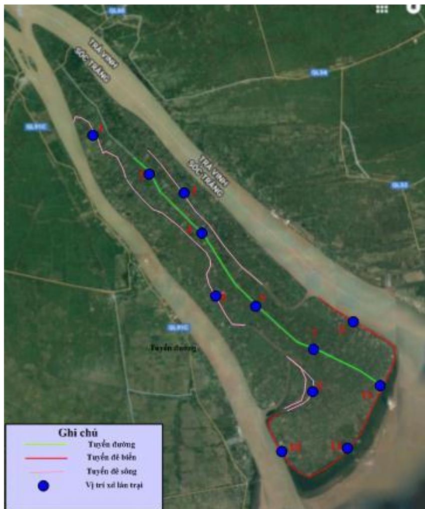
Hình 1. 19. Vị trí dự kiến xây dựng lán trại
